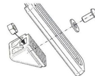
2 - Monter le sous-ensemble dans la semelle en fonction de la position du dormant
