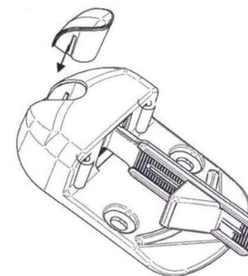
4 - Percer et fixer le sabot au sol, positionner le bouchon. (Avec des fixations adaptées au support -Ø8 maxi).
