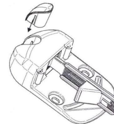
4 - Percer et fixer le sabot au sol, positionner le bouchon.
