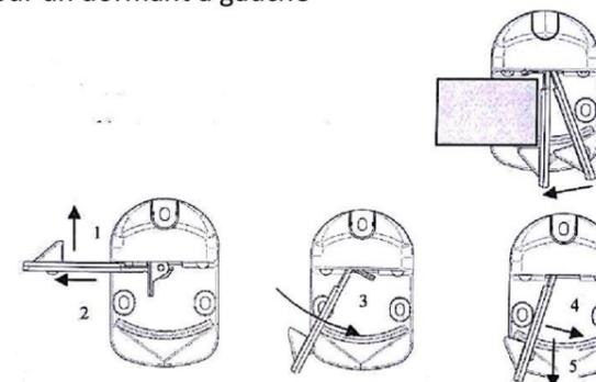
3 - Monter la cale de serrage et les amortisseurs
