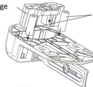
4 - Percer et fixer le sabot au sol, positionner le bouchon. (Avec des fixations adaptées au support -Ø8 maxi).
