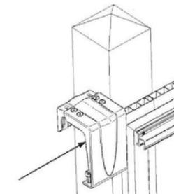
4- Glisser le patin (rep :4 ; fig.3) dans le rail et positionner l'ensemble sur le pilier avant perçage pour fixer l'équerre (rep :1).
