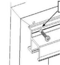
Ø Perçage dans le rail > Ø vis
