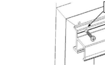
Ø Perçage dans le rail > Ø vis
