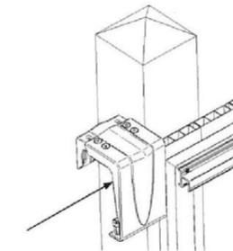
4- Glisser le patin (rep :4 ; fig.3) dans le rail et positionner l'ensemble sur le pilier avant perçage pour fixer l'équerre (rep :1).
